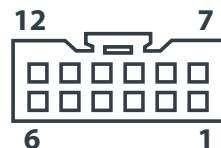
Рис. 1 Нумерация контактов в разъемах, вид со стороны проводов
